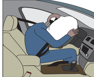
Movimiento del ocupante con el uso del cinturón de seguridad
