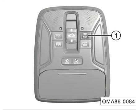
– قم بالضغط على المفتاح ① (المفتاح مضغوط) لتشغيل وظيفة التشغيل التلقائي لضوء السقف؛ اضغط على المفتاح ① (عودة المفتاح إلى موضعه) مرة أخرى لإيقاف وظيفة التشغيل التلقائي لضوء السقف.
