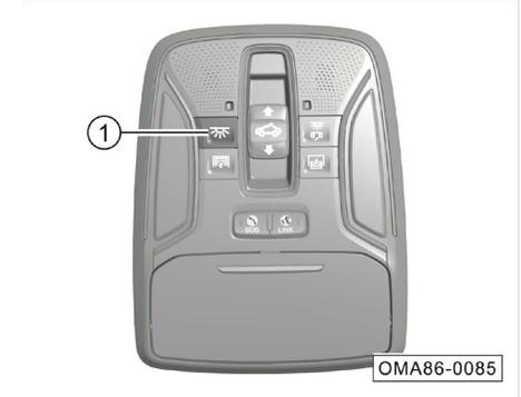
عندما تكون أضواء السقف مطفاً، قم بالضغط على المفتاح ① (المفتاح مضغوط)، وتكون جميع أضواء السقف مضاءة؛ اضغط على المفتاح ① (عودة المفتاح إلى موضعه) مرة أخرى، تكون جميع أضواء السقف مطفاً.
